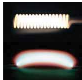
Porovnání vlákna halogenové žárovky a oblouku výbojky XENARC®.
